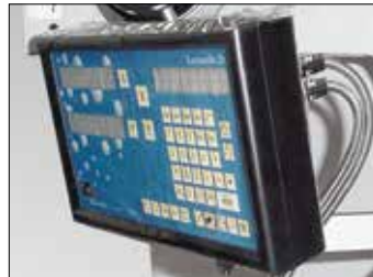
Code 40025: Digitalanzeige für X und Y Achsen
