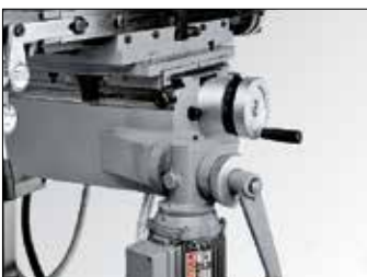
Code 40006: Eilgang für die Tischhöhenverstellung
