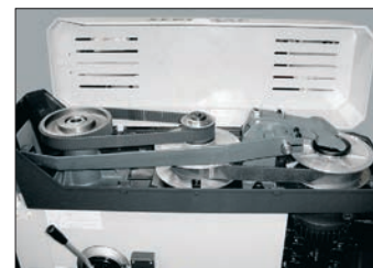
VS: Variator stufenlos.
