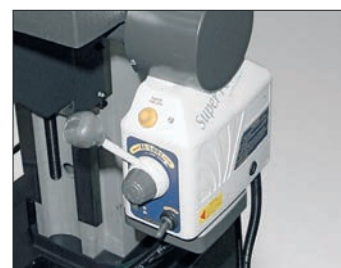
Cod. 40026 Power: Automatischmechanische Tischlängenverstellung
