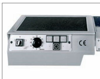
Cod. 40005: Automatisch- und elektronische Längenverstellung des Tisches. 36-380 mm/min. Schneller Vorschub 3 m/min.
