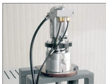
Cod. 40097: Spindel mit pneumatischer Werkzeugklemmung ISO 40.
