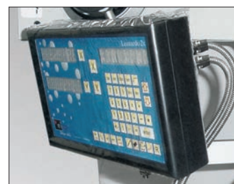
Cod. 40025: Positionanzeige der X + Y Achse
