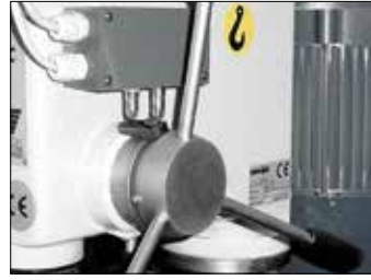
Cod. 18080: Gewindeschneideeinrichtung mit Drehrichtungswender.
