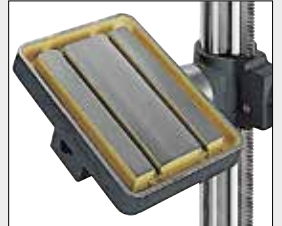
PG: 350 x 250 mm Schwenkbare Grundplatte
